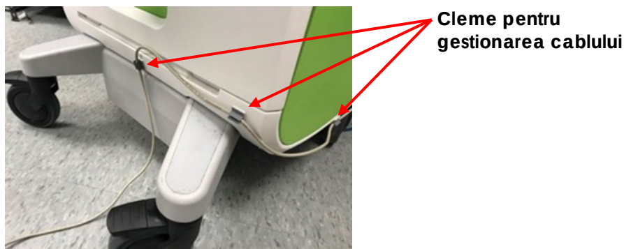
Figura 4: Gestionarea cablului pedalei pentru picior
