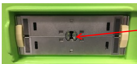
Figura 20: Canelură de blocare pe fanta conectorului transductorului
