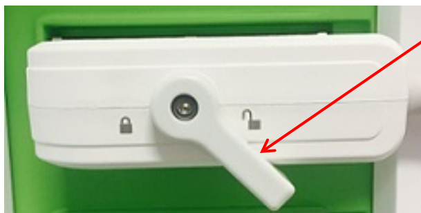
Figura 30: Butonul de blocare al conectorului transductorului deblocat
